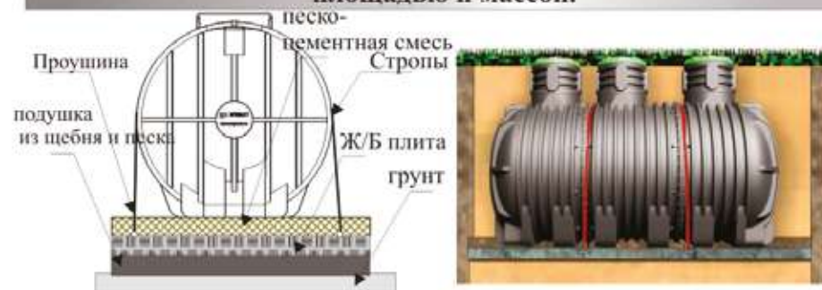
Рисунок 13. Схема установки подушки под плиту основание
